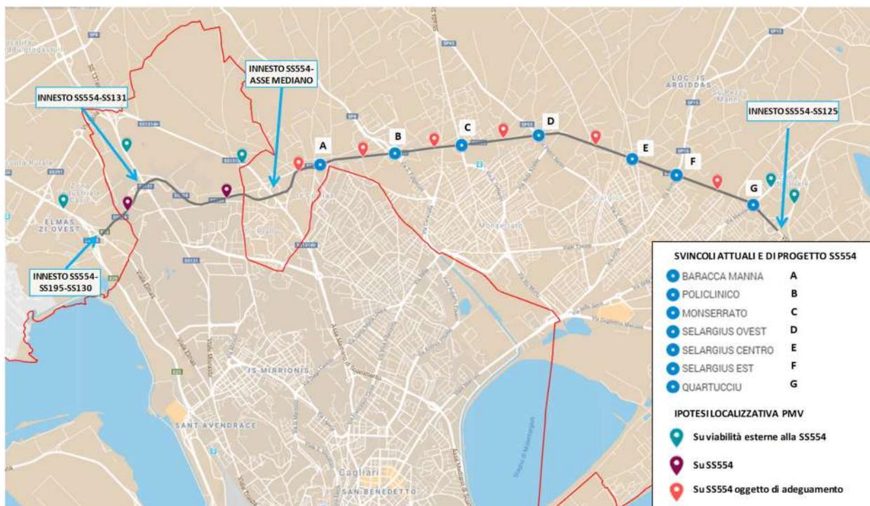
Schema posizionamento dei pannelli a messaggio variabile per l'indirizzamento dei traffici di attraversamento a Cagliari a seguito dell'adeguamento della SS554 Cagliariitana
