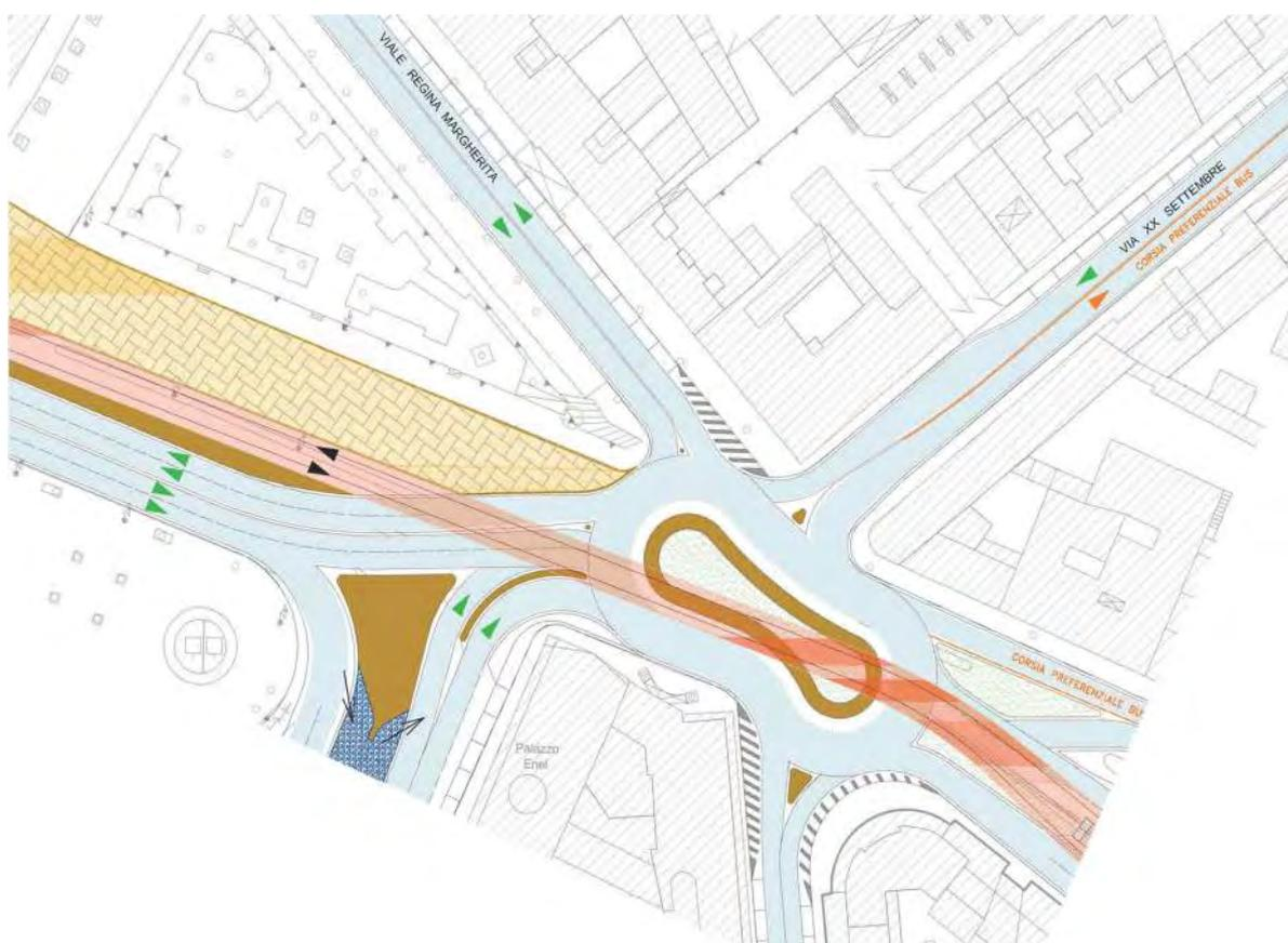
L'intersezione ipotizzata è una rotatoria a cannocchiale con diametri esterni di 34 e 33 metri e larghezza della corona giratoria di 9,5 metri. Nella configurazione di progetto i flussi veicolari provenienti da via Cristoforo Colombo per poter svoltare sul Lungomare N.Y. 11 settembre devono percorrere la rotatoria di progetto.
