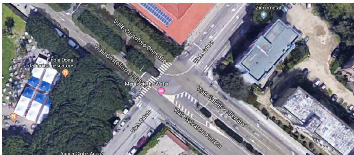
L'intersezione semaforizzata ha subito modifiche di messa in sicurezza delle svolte negli anni, attualmente non è permesso ai veicoli sul lato nord di via Caboto di svoltare a sinistra su Via Ferrara, infatti la corrente proveniente da Via Caboto può solo effettuare la svolta a destra su Via Cristoforo Colombo.
