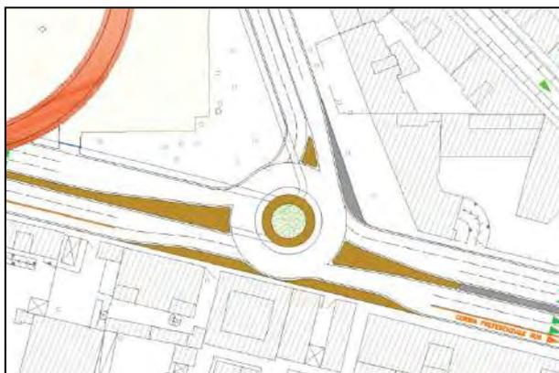
Lo schema progettuale proposto dal PUMS prevede l'introduzione di una rotatoria diametro esterno 33 metri e larghezza dell'anello circolatorio di 7 metri (si prevede anello sormontabile di 1,5-2 metri). La rotatoria proposta è a tre bracci con rami in ingressi tutti a doppia corsia, i rami in uscita.
