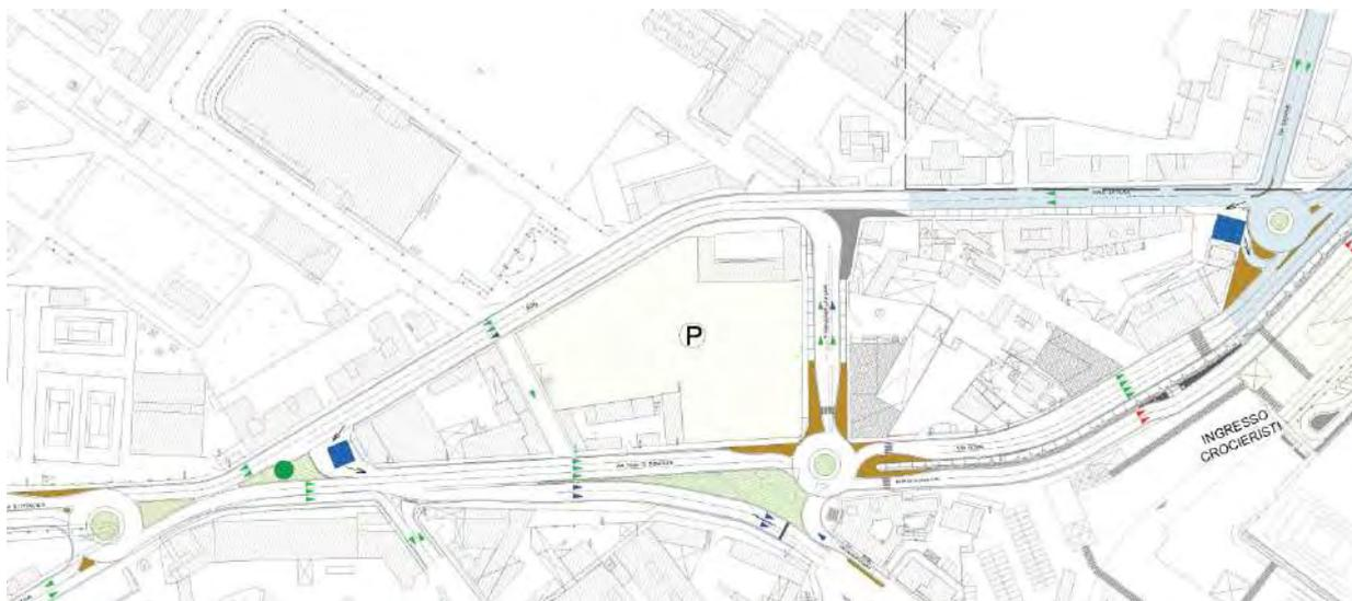
La soluzione di progetto ipotizzata dal PUMS per il comparto prevede la realizzazione di tre intersezioni a rotatoria:
