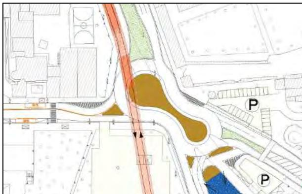
Lo schema progettuale proposto dal PUMS prevede l'introduzione di una rotatoria "a cannocchiale" con diametro esterno maggiore di 38 metri, diametro esterno minore di 31 metri e larghezza dell'anello circolatorio di 7 metri (si prevede anello sormontabile di 1,5-2 metri). I rami in ingresso sono 4 di cui Viale del Cimitero e Viale Bonaria da sud ed ovest a doppia corsia, i rami in uscita sono 4 di cui il ramo Viale Bonaria in
