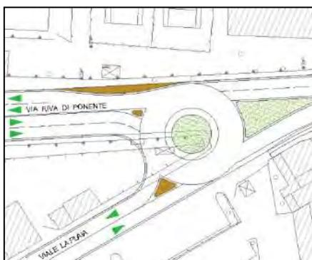
esterno di 30 metri e larghezza dell'anello circolatorio di 7,5 metri (si prevede anello sormontabile di 1,5-2 metri). I rami della rotatoria a est sono costituiti in ingresso da Viale La Plaia ed in uscita da Via Riva di Ponente.
