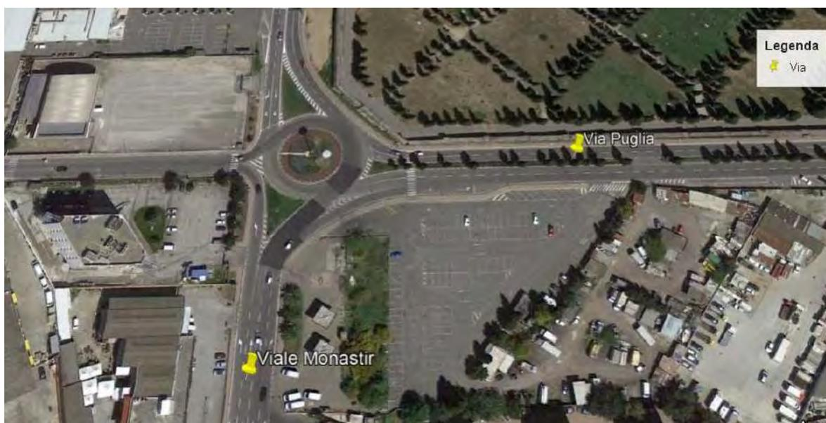
**L'intersezione presenta una rotatoria a 4 bracci.** I due rami, Viale Monastir (nord) e Via Puglia, sono a due corsie in entrata ed uscita, il braccio sud di Viale Monastir, a senso unico, entra con una sola corsia in rotatoria, in più presenta la corsia di svolta a destra diretta su via Puglia. Il braccio di via del Fangario è solo in uscita dalla rotatoria.
