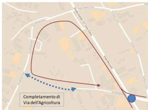
Nel ridisegno del nodo emerge la criticità legata ai flussi di traffico provenienti da sud e da est in direzione di via dell'Agricoltura, in quanto le manovre possibili in ingresso/uscita dalla strada sono agevolate solo per chi proviene da nord. Con l'eventuale completamento di Via dell'Agricoltura, gli utenti provenienti dal centro di Cagliari potrebbero giungere, nel tratto interdetto dalla sistemazione del nodo in esame, con la stanza di circolazione che verrebbe a formarsi.
