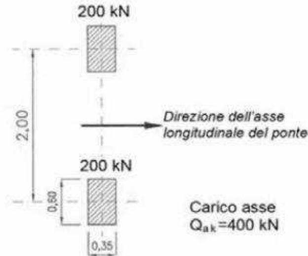
Ai fini del dimensionamento dei nostri manufatti (a meno dei casi in cui l'ingombro del treno di carichi non rientrasse nel perimetro delle solette) è stata considerata la presenza sull'impalcato delle solette di ciascun pozzetto dello **schema di carico 1 e dello schema di carico 2 (quest'ultimo solo nel manufatto Caracalla)**.
