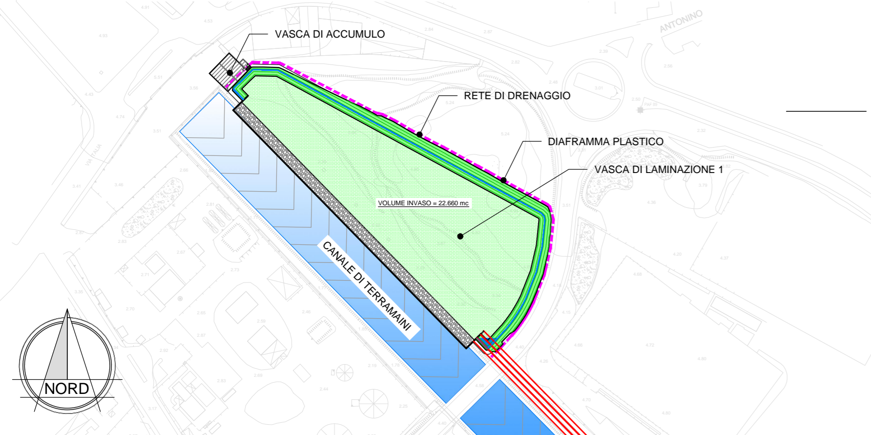
RETE DI DRENAGGIO E DIAFRAMMI PLASTICI SEZIONE TIPO Scala 1:100
